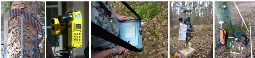
**Abbildung 3.2:** Aufnahmegereäte der BWI 2012, u. a. Hochkluppe, Criterion, Feldcomputer, Kompass, Spiegelrelaskop, Vertex, GNSS-Gerät, Maßband, Kluppe
